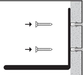
**Carga suportada: 8 kg no drywall e concreto**
